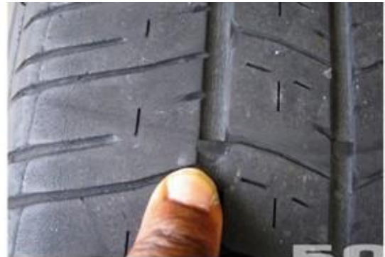
Fotografía 2: Indicador de desgaste del neumático (Neumático gastado)
