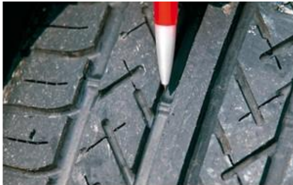
Fotografía 1: Indicador de desgaste del neumático (Neumático en buen estado)
